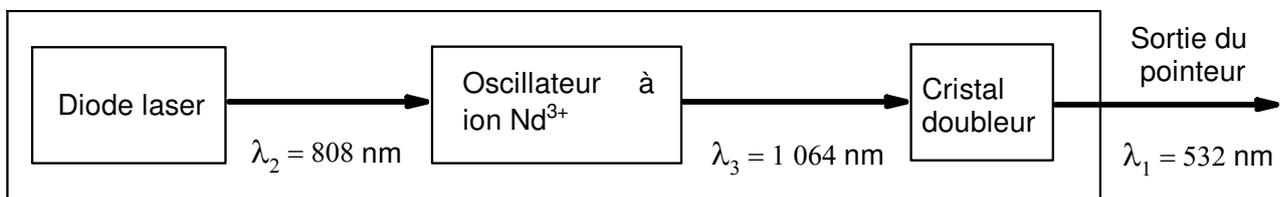
Figure 3 : principe de fonctionnement d'un pointeur laser de longueur d'onde 532 nm
