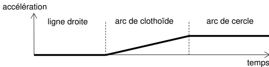
Figure 2. Évolution de l'accélération sur un raccordement routier
