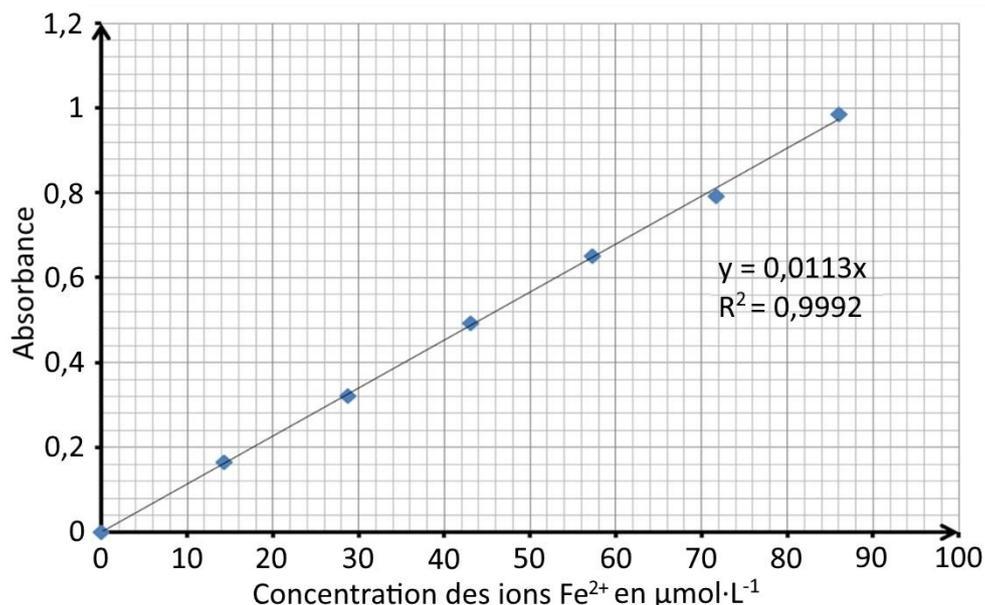
Figure 3. Courbe d'étalonnage
